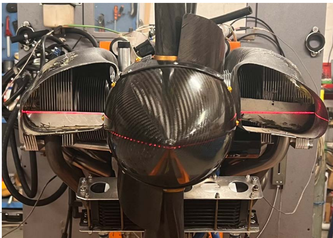
Foto 7: a destra è visibile la parzializzazione eccessiva dell'ingresso dinamico
