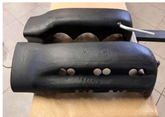
Foto 1: i convogliatori Ram Air di un sei cilindri
