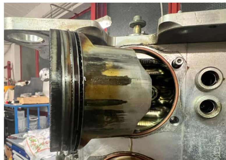
Foto 8: i segni di grippaggio sul pistone posteriore
