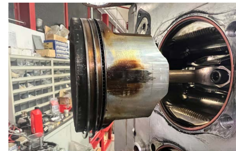
Foto 9: sull'altro pistone posteriore segni di grippaggio e olio carbonizzato sul mantello
