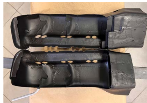
Foto 2: all'interno dei Ram Air si notano i baffle, con feritoie di passaggio, che deviano parte del flusso verso teste e cilindri
