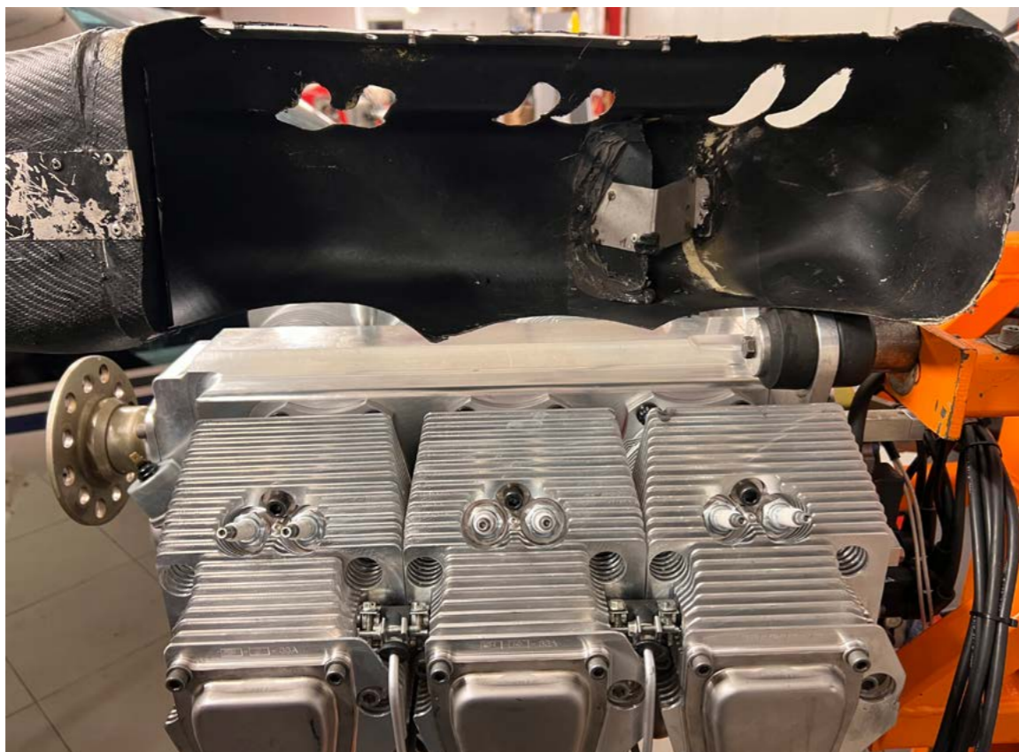
Foto 6: un solo baffle senza feritoria di passaggio ha praticamente interrotto il flusso sul cilindro posteriore
