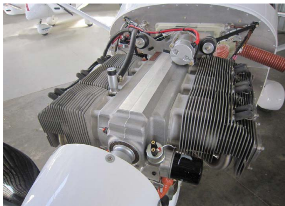
Il Jabiru 6 cilindri quarta generazione installato sul velivolo Jabiru J230
