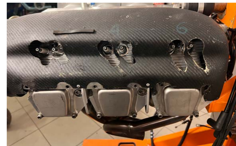
Foto 4: le aperture per le pipette candele di grosse dimensioni hanno fortemente ridotto il flusso utile
