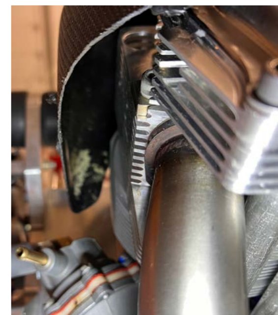
Foto 5: la spaziatura troppo elevata tra convogliatore e testa
