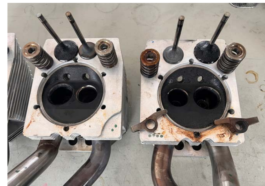
Foto 10: Su questo quattro cilindri evidente la carbonizzazione sulle valvole e il trafilaggio di olio tra teste e cilindri
